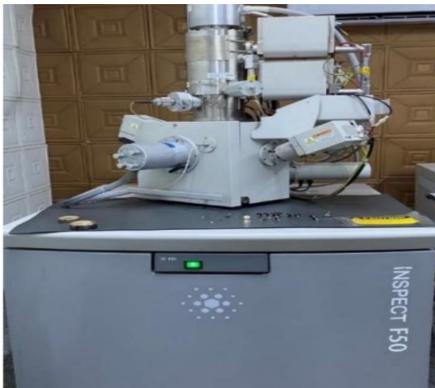
Fig. 3. SEM Test Device
